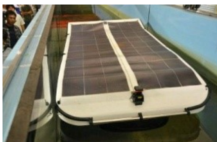
長崎大の実験棟で試運転するアオコ処理の舟形ロボット
